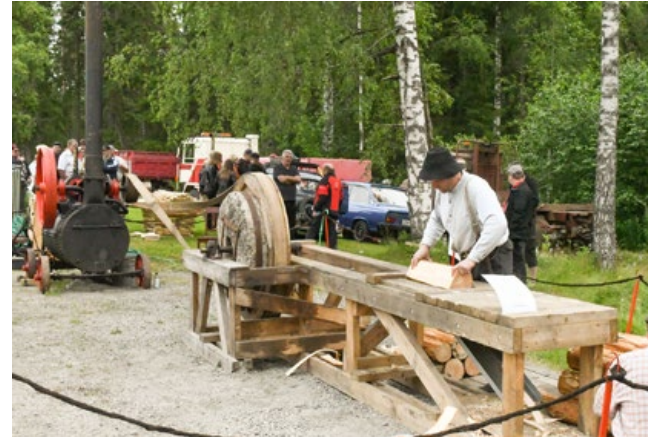
Pärettä syntyi Harjulan höyrykoneen pyörittäessä vuoden 1905 pärehöylää.
